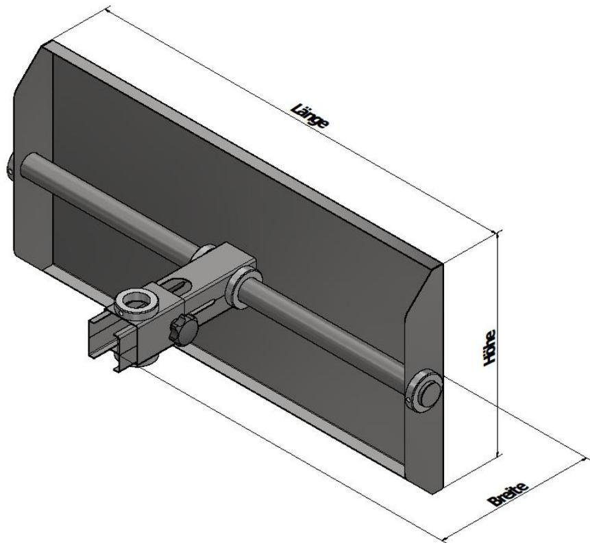
**Kontrollspiegel VS Typ-B > Siegel-Profilblech mit verstärkter Aufnahme als Drehlager, Traversen-Rohr als Drehachse beidseitig verschlossen, Verstell-Einheit zur horizontalen und vertikalen Positions- und Winkelverstellung**
